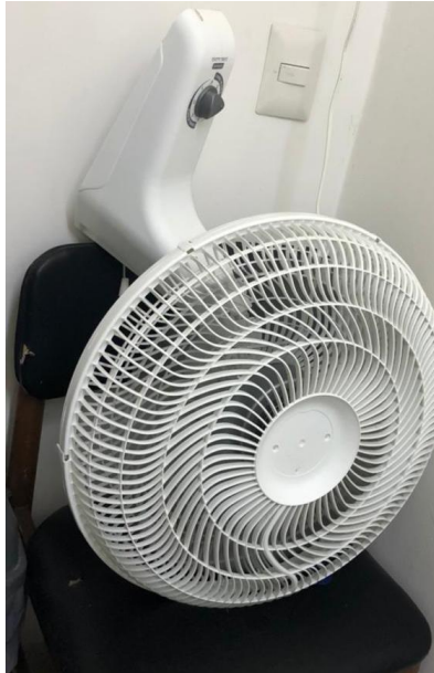
Ilustración 6. Ventilador con cabezal desprendido, IPS CUNDINAMARCA
