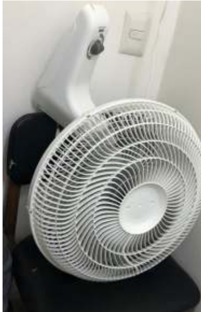
Ilustración 6. Ventilador con cabezal desprendido, IPS CUNDINAMARCA
