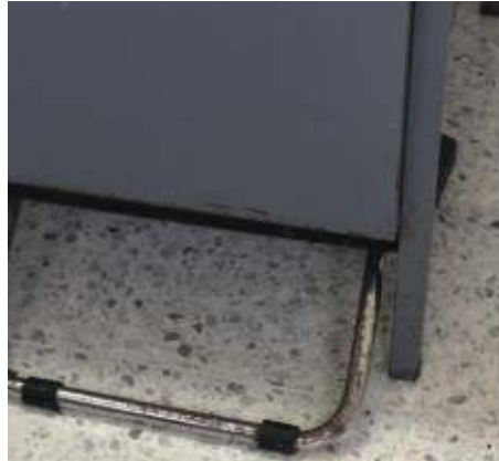
Ilustración 4. Reposapiés con oxido, IPS CUNDINAMARCA
